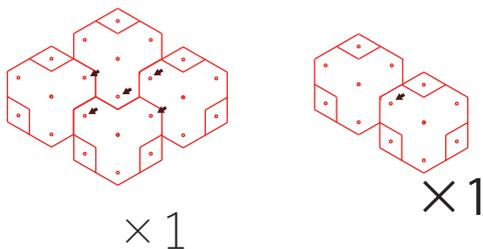
※ソケットを装着してから、ネジやピンを貫通させてください。ソケットは裏表があります。小さい羽をパネルの隙間に入れるようにしてください。
