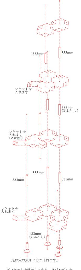
※ソケットを装着してから、ネジやピンを 貫通させてください。ソケットは裏表があり、 小さい羽をパネルの隙間に入れてください。
